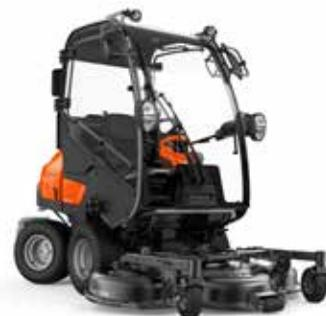
Die geräumige, vibrations- und geräuscharme Kabine mit Glastüren, Panoramafenstern und einem Grammar Sitz überzeugt mit Komfort zu jeder Jahreszeit. Ausgerüstet mit Scheinwerferlicht, Gegengewicht, Heizung, Signallampe etc.. Die Kabine kann einfach vom Chassis demontiert werden, wenn sie z.B. im Sommer nicht benötigt wird. Überrollbügel (ROPS) integriert.
